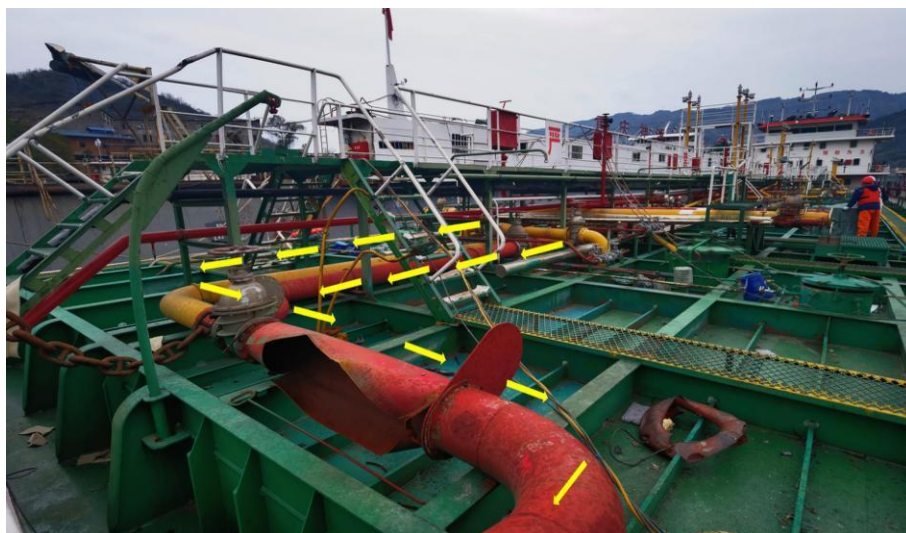
图 15：丙酮蒸气通过除气管路进入 1 号空舱示意图（1）
