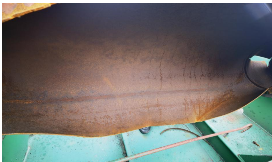
图 3：钢质短管内部线状液体浸痕
