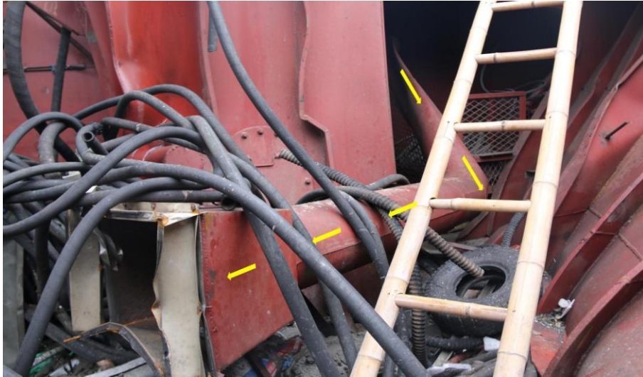
图 17：丙酮蒸气通过除气管路进入 1 号空舱示意图（3）
