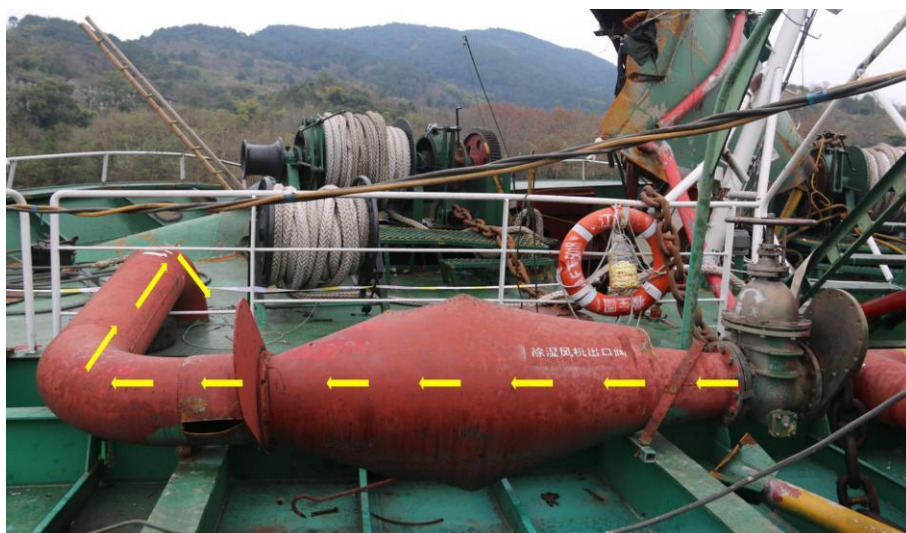
图 15：丙酮蒸气通过除气管路进入 1 号空舱示意图（1）
