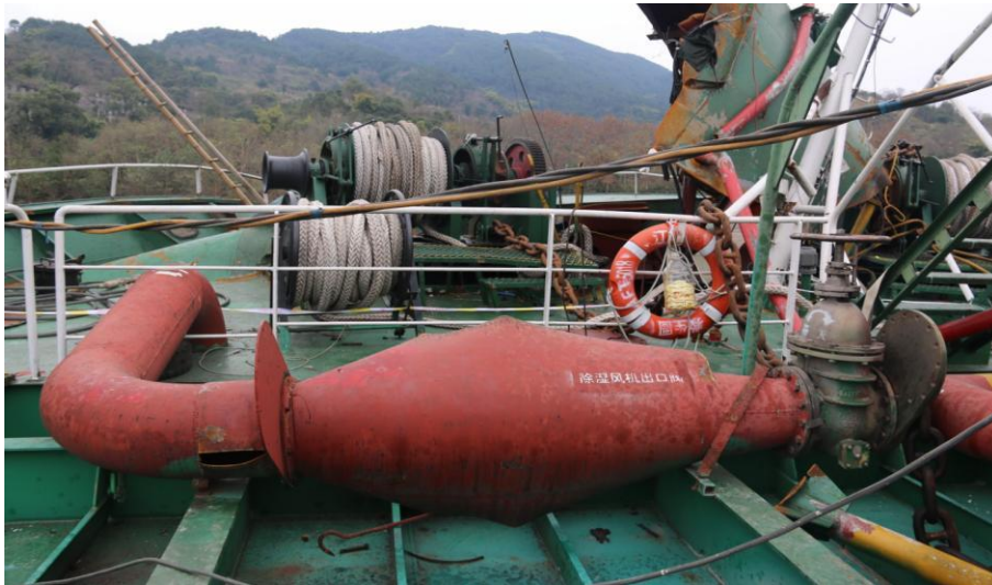
图 4：盲板+闸阀+可拆钢质短管+盖板
