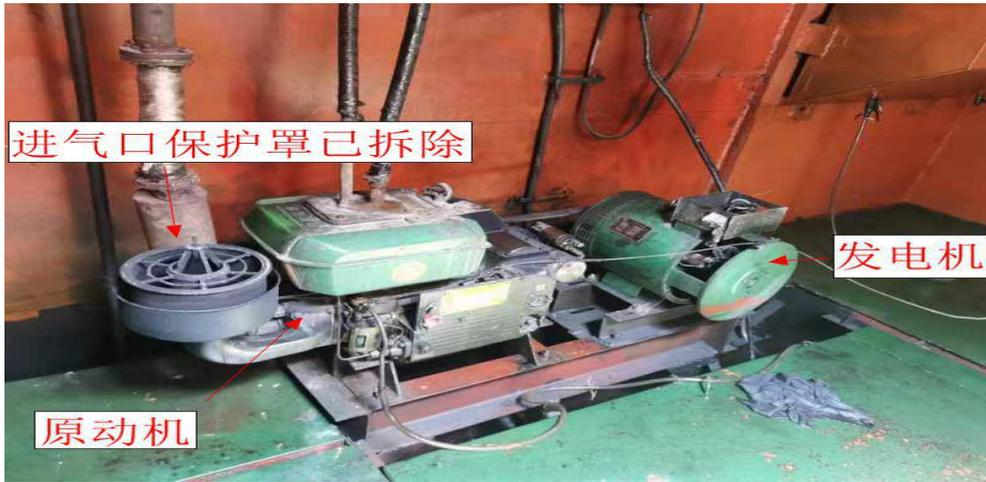
图 4：“X”轮船首左侧空舱发电机（组）
