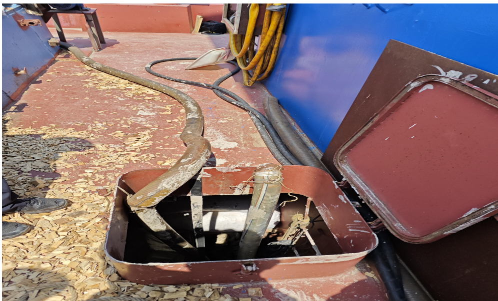
（隔离空舱舱口、水泵排水管）
